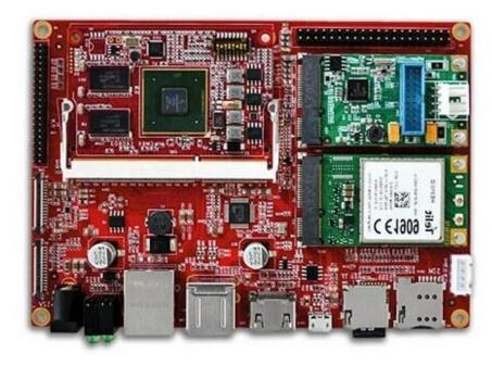
Processor: i.MX6 Cortex<sup>TM</sup> A9 MPCORE<sup>TM</sup>
